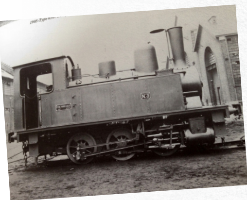
1906-1907 - Type 67 : Locomotive des ateliers de Fives. Poids à vide : 19 900 kg.
