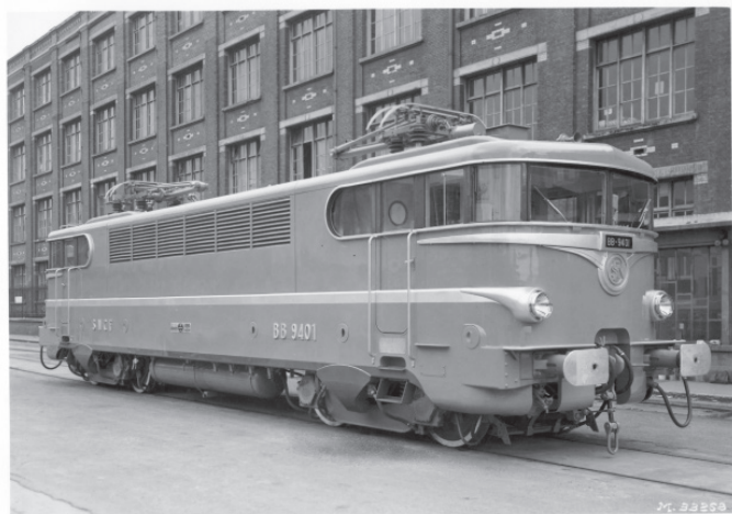
LOCOMOTIVE ÉLECTRIQUE B.B. SÉRIE 9400 POUR COURANT CONTINU 1 500 V. A BOGIES MONOMOTEURS - PUISSANCE : 3 300 CH
